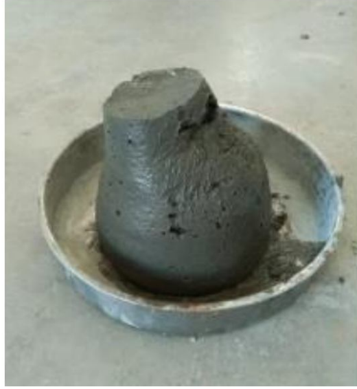
Şekil 2.1: Otomatik yapı üretimine uygun taze beton örneği [5].
